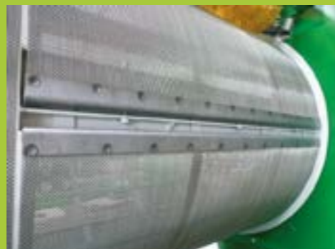
VARIABLE SIEBBESPANNUNG (INNEN- & AUSSENTROMMEL)
