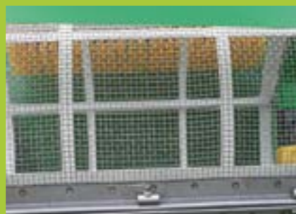
EINFACHTROMMEL MIT DRAHTSIEBBELAG
